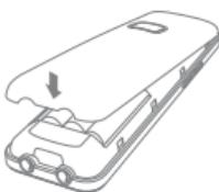
– 배터리 교체 시 충전용 Ni-MH 1.2V AAA 배터리만 사용하고 위 그림대로 설치 및 교체하십시오.
